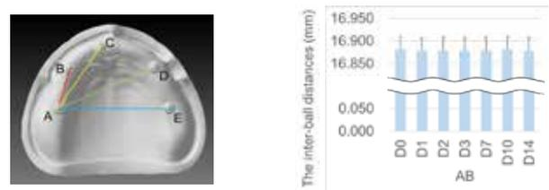
図13. 3Dプリンタで製作した模型の経時的な寸法変化
